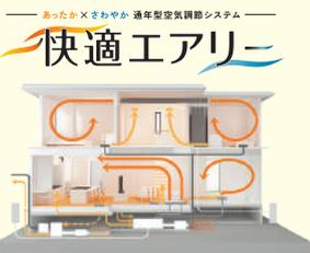
ヒートポンプ式エアコンと高性能換気を組み合わせたシステム。家全体に心地よい空気を供給します。
