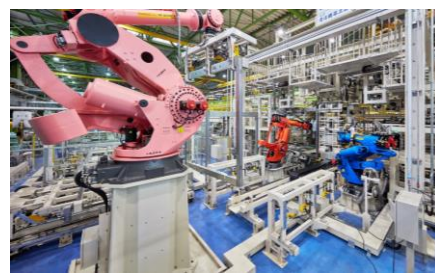
▲構造体溶接工程
